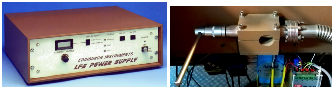
Рис. 1.4. Слева – источник питания лазера. Справа – вакуумный кран на корпусе лазера.
