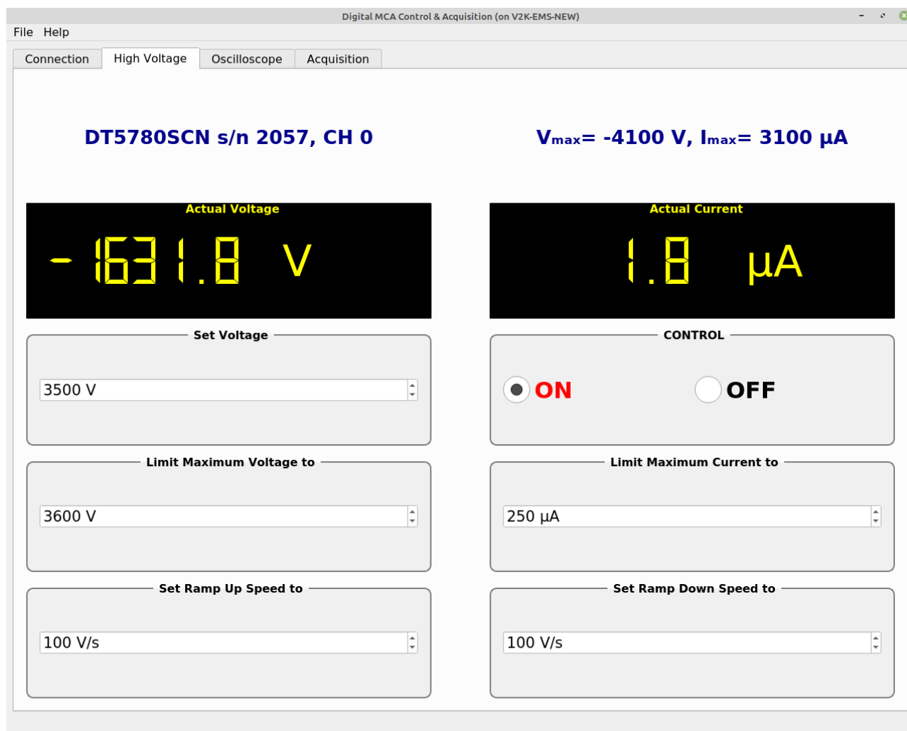
Рис. 2.4. Графический интерфейс управления высоким напряжением.
