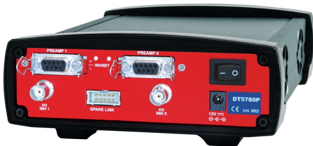
Рис. 1.7. Спектрометрическая станция CAEN-DT5780 (задняя панель). При поступлении сигнала «HV Inhibit» высокое напряжение аппаратно выключается и светодиод «INHIBIT» загорается красным цветом.
